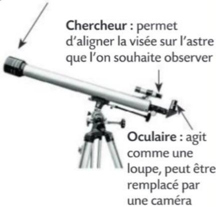
➤ La mise au point, lors de l'observation, se fait en modifiant la longueur du tube entre l'oculaire et l'objectif.
